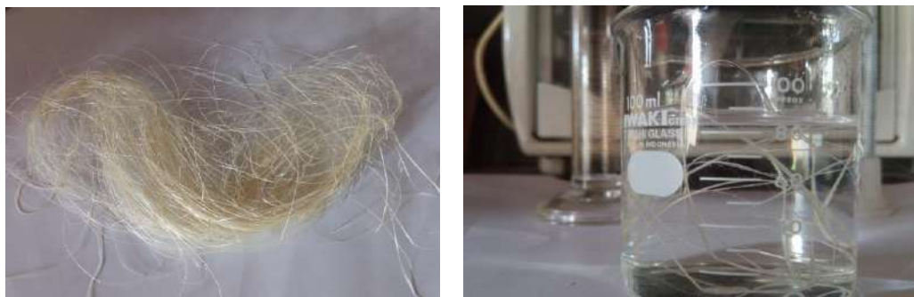
Gambar 1. Serat sago dan perendaman sedalam larutan NaOH + H 2 O
