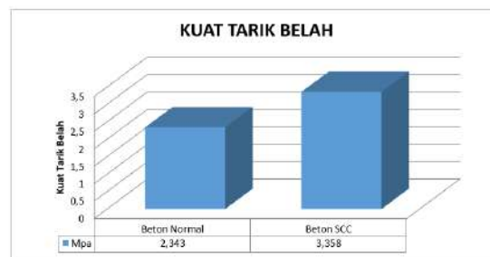
Gambar 3. Grafik perbandingan hasil pengujian kuat Tarik belah pada beton SCC dan beton normal.
