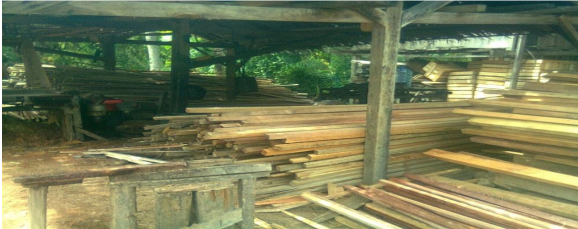
Gambar 2. Mesin penggergajian, papan list dan balok kecil hasil pengolahan limbah kulit kayu gergajian
