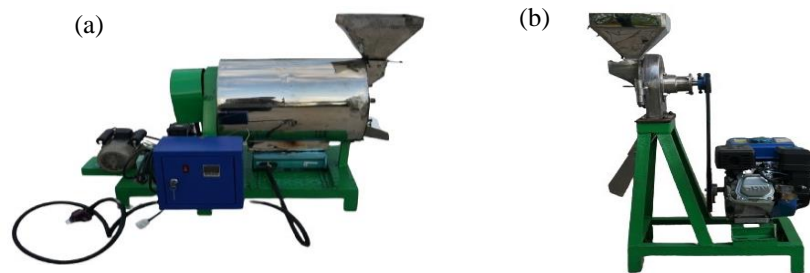
Gambar 6. (a) Alat Penyangrai Kopi Pinang dan (b) Alat Penepung Pinang
